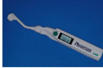
図5 口腔水分計モイスチャーチェッカー・ムーカス改良型では、センサー部分が緩圧式に工夫されている。
