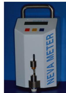
図7 曳糸性測定器(ネバメーター) 唾液の糸引き度を電氣的に自動測定する。粘度とも相関がある。
