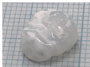
図1 3Dプリンタで造形したエナメル質と同じ硬さと実用強度をもつクラウン
