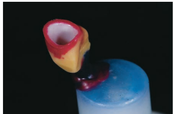
図13 ワックスフォーマーにスプーリングを行う。スプールの太さは最低3.3 mmの直径のものを使う。湯口からの距離は3 mmが目安。リングフォーマー上面に対して30～60度の傾斜角をもって植立する。
