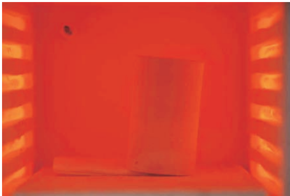
図 15 本埋没材では, 15 分後に 850 度のリングファーネスに挿入する. 焼却されたワックス成分やガスが出やすいよう, 鑄型はやや斜めに設置する.
