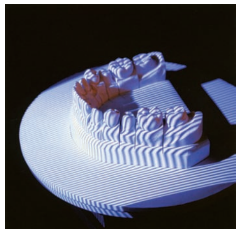
図3 Pattern light projection to digitizing (Hint-ELs hiScan) 計測対象にパターン光を投影するもの (写真は Hint-ELs hiScan)
