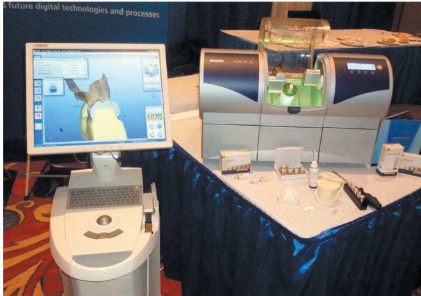
図8 An intra-oral scanner and a milling machine (Cerec AC, Sirona, Bensheim, Germany) To take a digital impression, a hand-piece with CCD cameras is put into the mouth. 口腔内スキャナーとミリングマシン (Cerec AC, Sirona, ベンスハイム, ドイツ) CCD カメラを備えたハンドピースを口腔内に入れて歯列のデジタル印象を行う。
