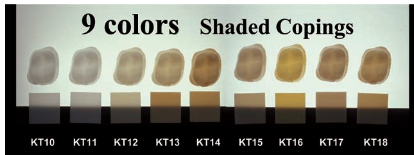
図 5 ノリタケ Katana コーピングの透過光試験
