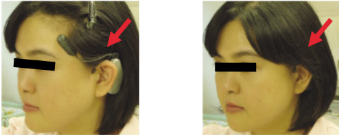
図1 携帯型筋電計の開発 小型，軽量で日常生活環境に影響を与えにくいように設計されている。
