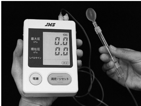
図2 JMS 舌圧測定器本体は、片手で把持でき、訪問診療にも対応した簡単軽量の口腔機能検査機器である。
