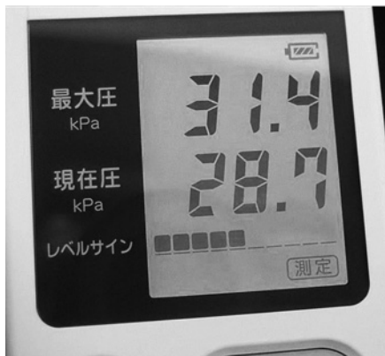
図4 舌圧測定時の本体表示 測定中の最大舌圧（最大圧）、リアルタイムの測定値（現在値）がキロパスカル（kPa）単位で読み取れるとともに、レベルサインとして左から右への黒色ブロックの数の増減としてリアルタイムに表示される。
