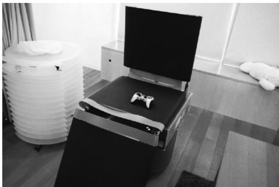
図9 共生ロボットと移乗機能を備えた全方向移動車椅子
