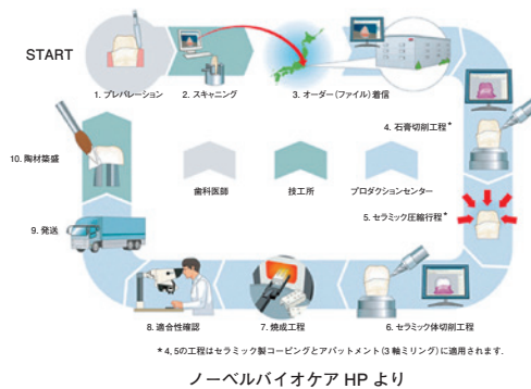
図3 2000年に日本に入ってきたノーベルバイオケア社のプロセラシステムの概要と症例
