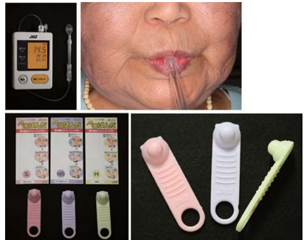
図6 舌圧計による舌圧の計測(上段)と舌圧のトレーニング機器(ペコぼんだ, JMS)(下段)
