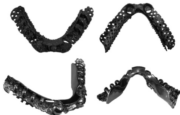
図9 上段：コバルトクロム粉末を粉末焼結積層造形法にて製作した直後の補強構造体 下段：研磨後の補強構造体
