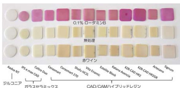
図7 ジルコニア (1 種), ガラスセラミックス (2 種) および CAD/CAM ハイブリッドレジン (10 種) を 37°C の 0.1% ローダミン B 溶液 (上段) および赤ワイン (下段) に 14 日間浸漬後の外観写真. 中段は浸漬前
