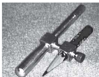
図9 コンダイラマーカ. 金属桿を外耳孔に挿入して回転させると, 外耳孔の前方に半径 13 mm の円弧が描ける。
