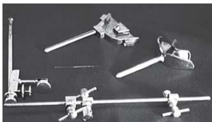
図5 ヒンジアキスロケーター (アルモア社)
